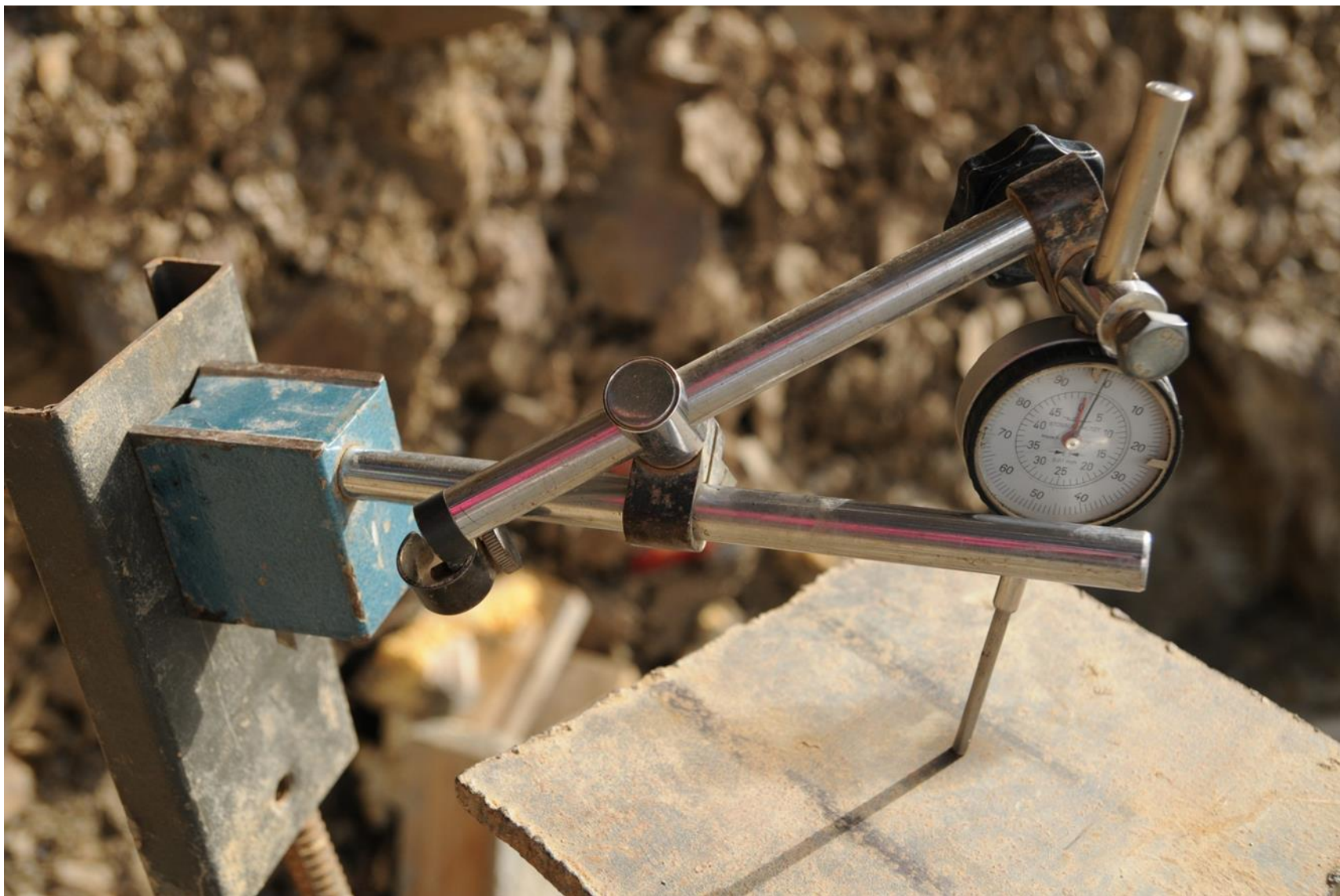
Испытания нагрузкой до 120 тонн
